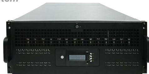
EP-4643系列的磁碟陣列容錯系統彈性地配備16G FC-AL光纖及12Gb SAS介面作為主機端(Host)連接選擇，可在4U的機架空間內安裝高達64顆可熱插拔的SAS3 / SATA3的硬碟，並可串接高達256顆硬碟，提供高效能、高容量及高擴充性的優異特色。EP-4643D2系列提供雙控制器(Dual Controller)以提供更好的容錯能力和更高的可用性，滿足企業對資料儲存的全面要求。
