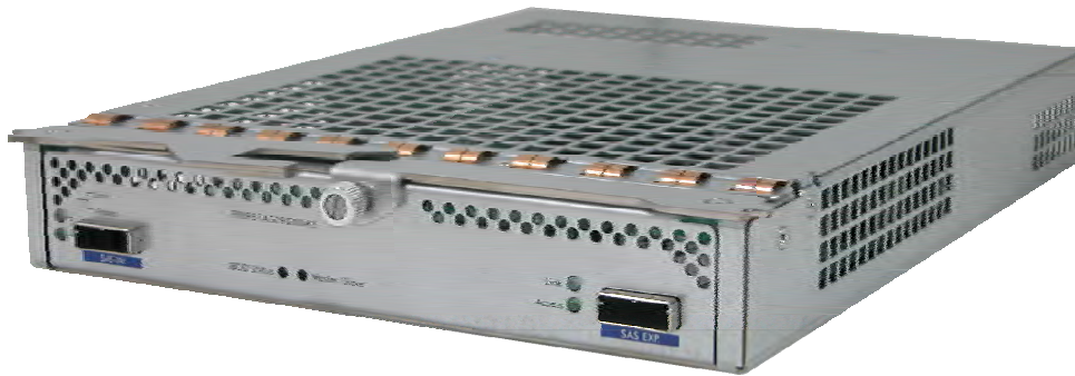
JBOD Controller Module
